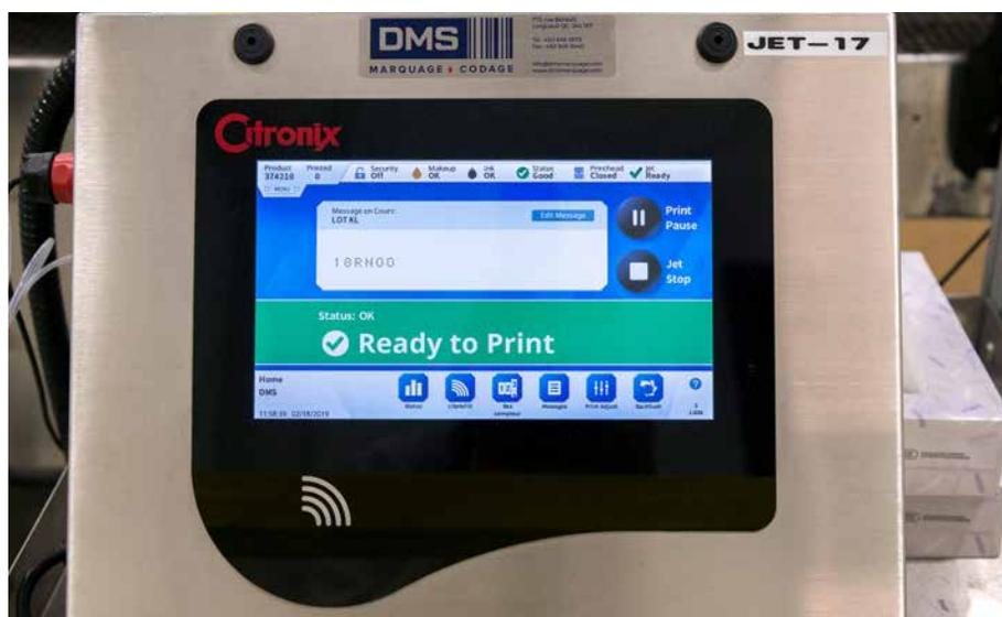
L'écran de contrôle de l'imprimante à jet d'encre continu ci5300, de Citronix, fournie par DMS Marquage Codage.
