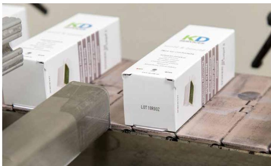
Un appareil à jet d'encre continu ci5300, de Citronix, fournie par DMS Marquage Codage, vient tout juste d'imprimer un code sur un emballage.
